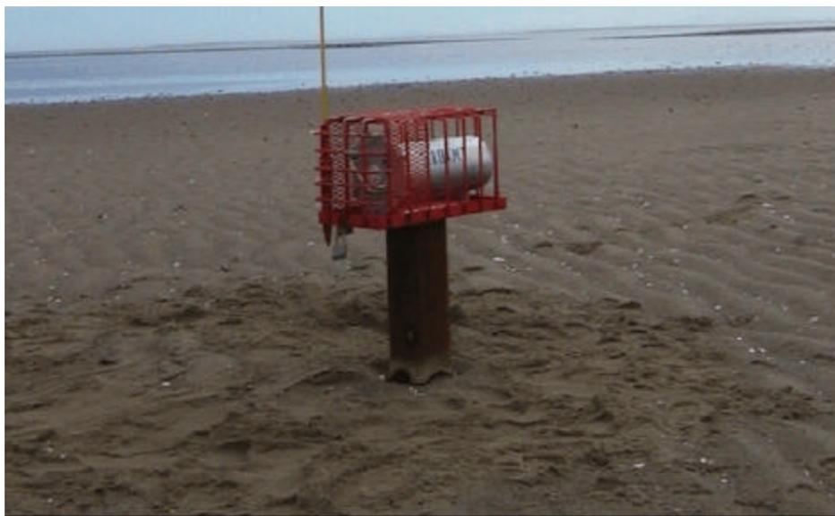
**Figure 9: Appareil de type Dobie qui sert à mesurer la pression hydrostatique engendrée par les vagues et les marées**
